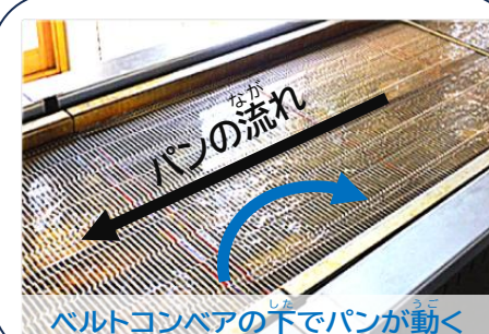
②パンがベルトコンベアに乗って矢印の方向に流れて揚がっていく
